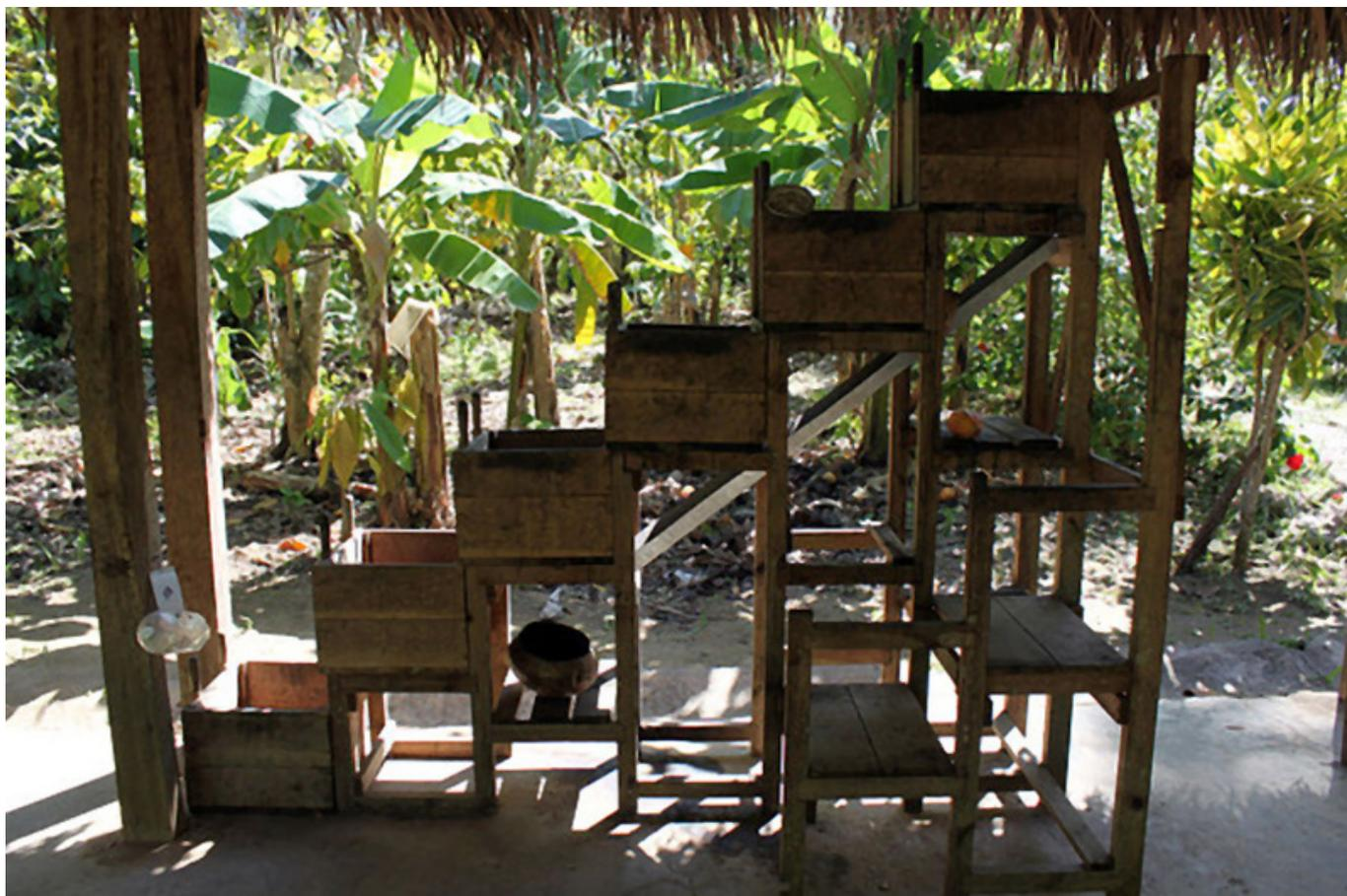
*Los cajones son cajas de base cuadrada de 60 a 100 centímetros de ancho y de 60 a 100 centímetros de alto...*
