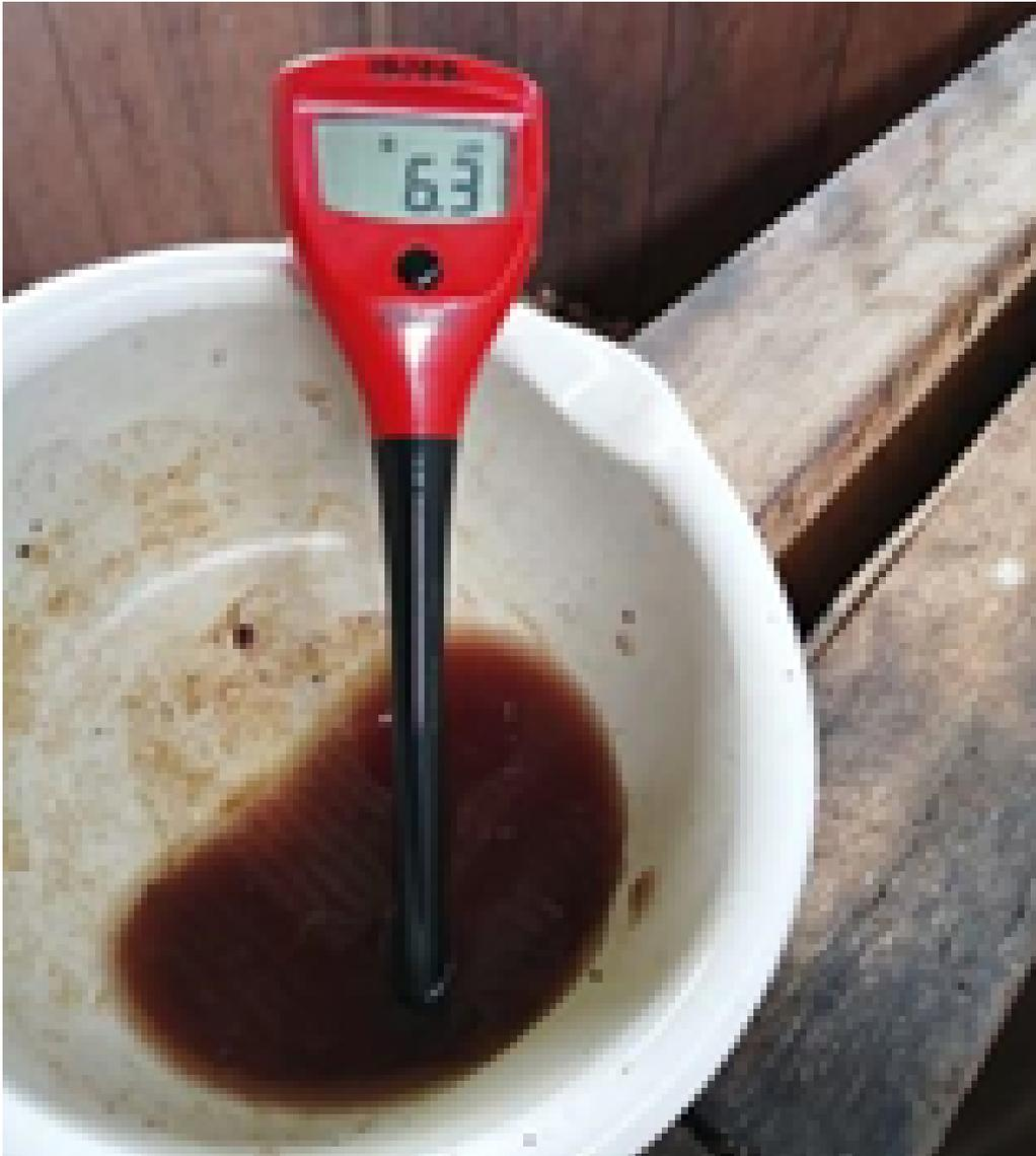
*Un pHmetro o medidor de pH es un instrumento que mide la actividad del ion hidrógeno indicando su grado de acidez o alcalinidad expresada como pH.*
